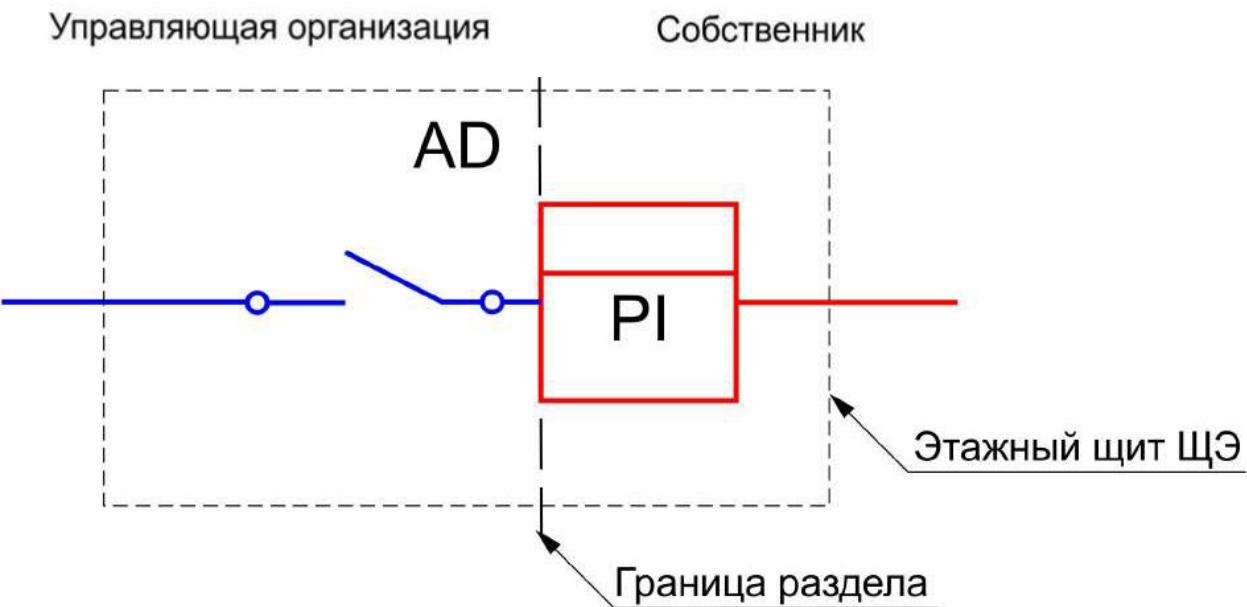
**AD** – вводной автоматический дифференциальный выключатель. **PI** – узел учета электрической энергии.
